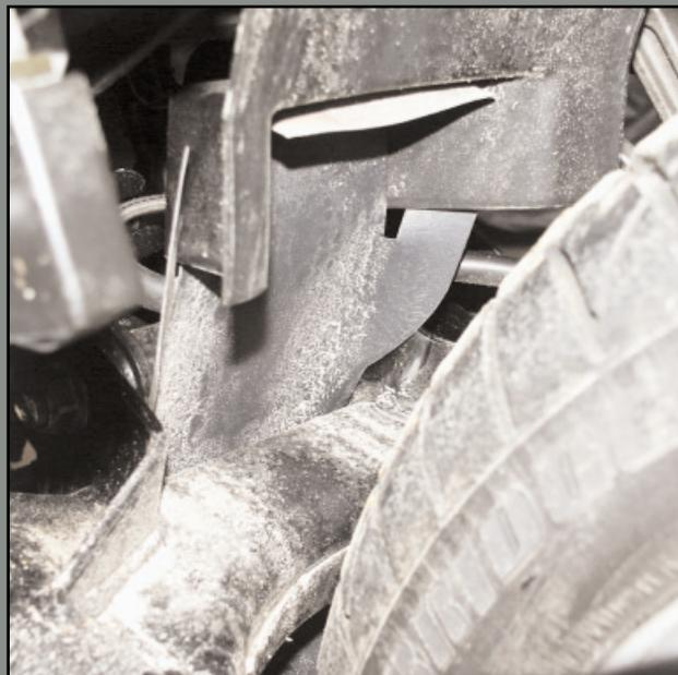
Das ganze von unten: perfekter Schutz für das Federbein. Auch der Luftfilter wird nicht mehr so schnell mit Staub und Dreck zuge-schleudert.
