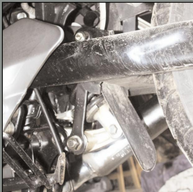
**Tipp: Einfach die 2. Seite auf DIN A4 ausdrucken und mit dem Fotokopierer vergrößern bis es passt. Dann nach der Schablone das Schutzblech zuschneiden.**
